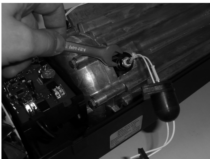
Рисунок 9 Отворачивание свечи накаливания
