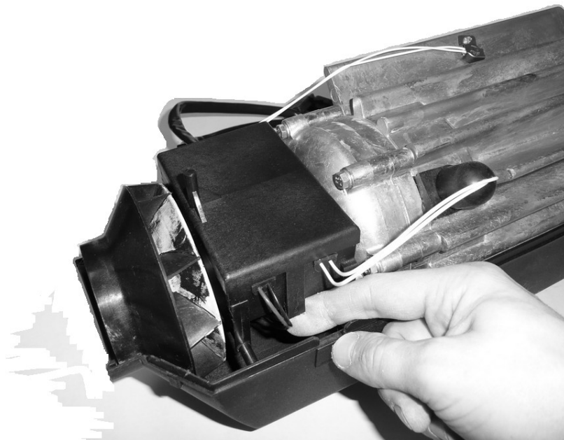
Рисунок 6 Вывод из зацепления защелок крышки блока управления
