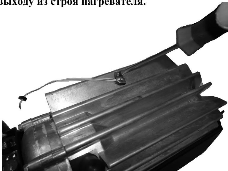
Рисунок 11 Демонтаж датчика перегрева
