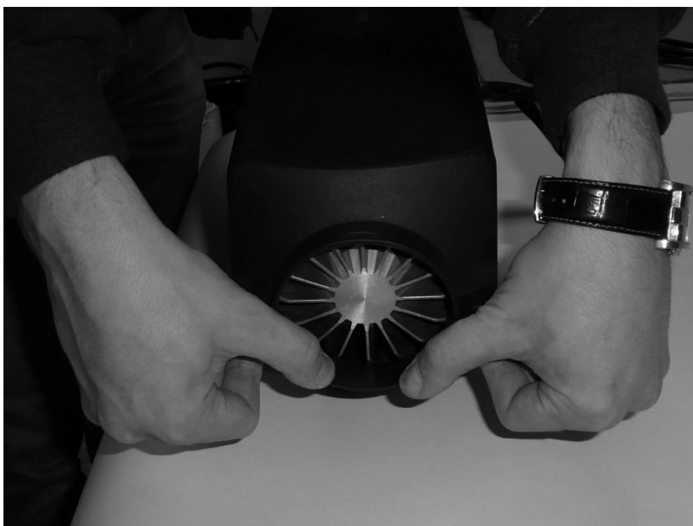
Рисунок 4. Вывод из зацепления защелок со стороны теплообменника
