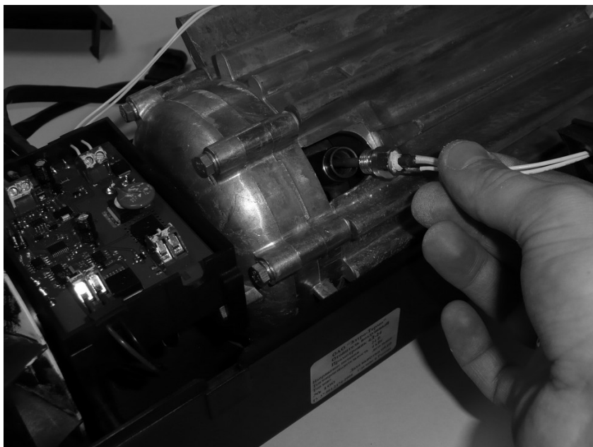
Рисунок 10 Вынимание свечи накаливания
